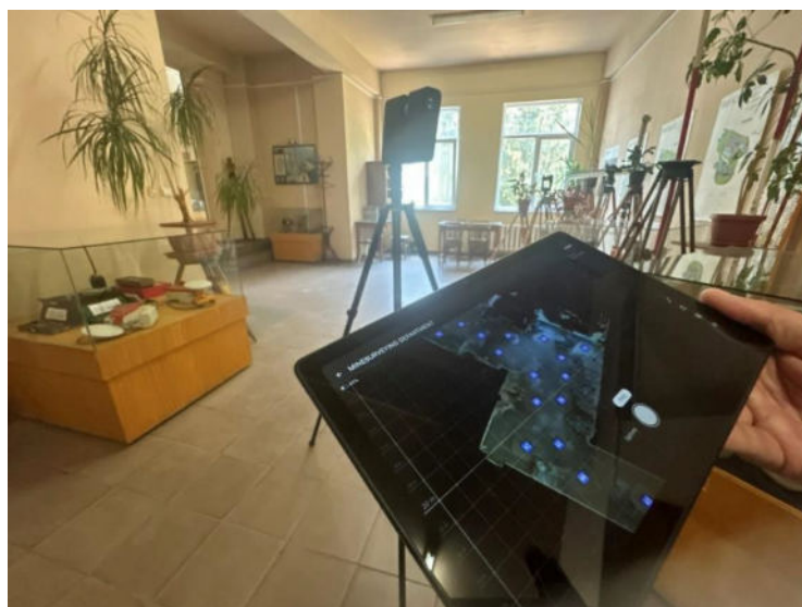
Фиг. 2. Заснемане с Matterport Pro 3
